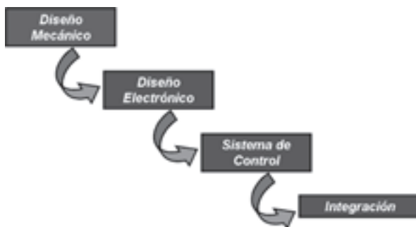
Figura 5. Etapas del diseño mecatrónico.
